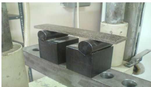
شکل ۳-۲۳ نمونه مستطیلی شکل برای انجام آزمون خمش
