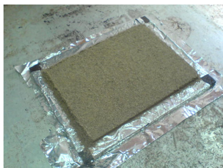
شکل ۳-۱۴ برداشتن چارچوب و قطعه پیش پرس
