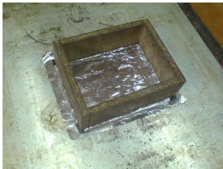
شکل ۳-۱۱ قرار دادن چارچوب بر روی شابلون
