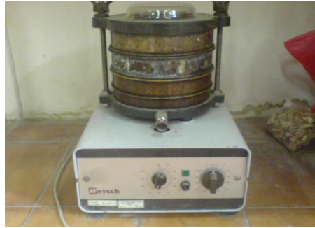
شکل ۳-۸ الک الکتریکی (راست)، تصویر شماتیک الک (چپ)
