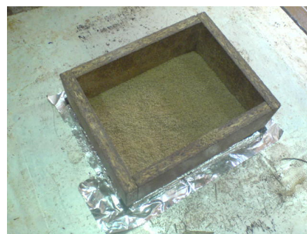
شکل ۳-۱۲ توزیع یکنواخت پلت‌ها درون شابلون و چارچوب شکل ۳-۱۳ مرحله پیش پرس
