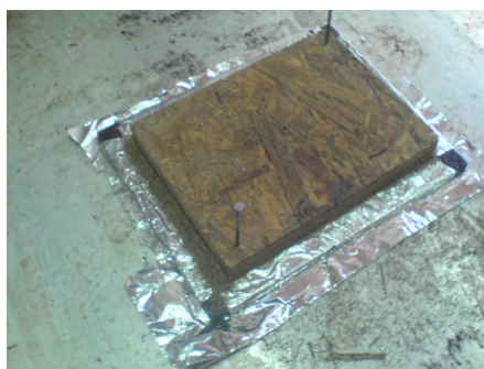
شکل ۳-۱۴ برداشتن چارچوب و قطعه پیش پرس
