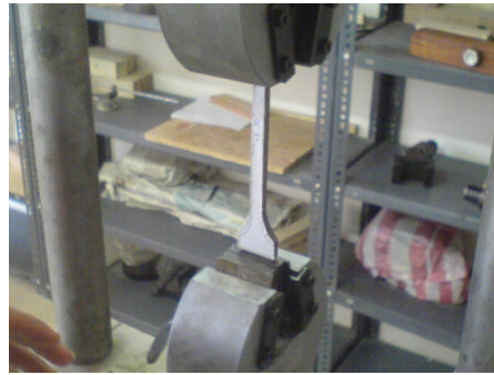
شکل ۳-۲۴ نمونه‌ی دمبلی شکل برای انجام آزمون کشش
